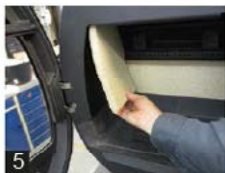
5 Устанавливать боковую левую пластину в требуемое положение, начиная сверху
