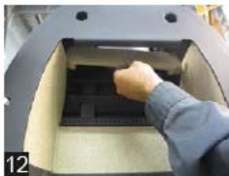
12 Поднять пластину над боковыми пластинами
